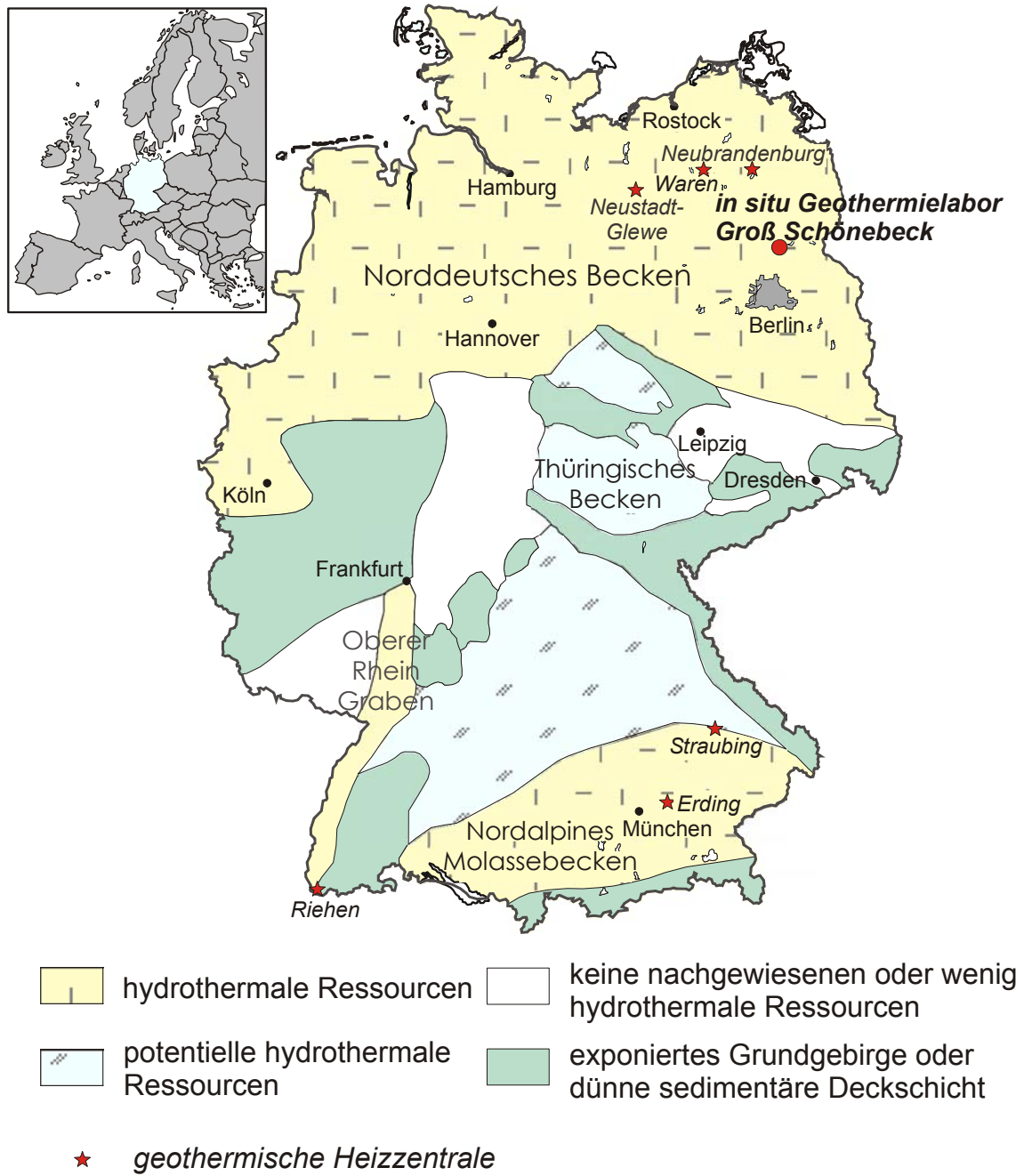
Abb. A-3: Sedimentbecken mit Bedeutung für die hydrothermale Erdwärmennutzung in Deutschland /Huenges et al. 2002/.
