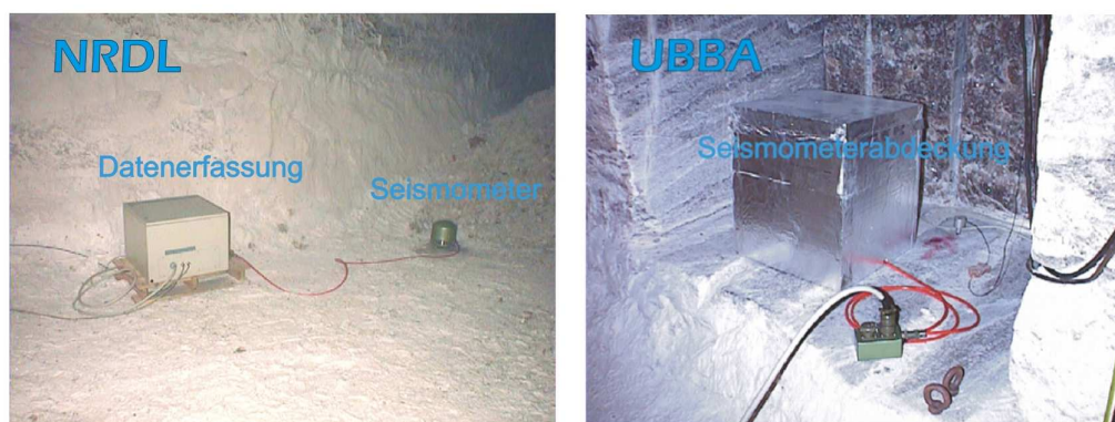
Abbildung 6.7: Seismometer-Standorte (unter Tage) an den Stationen NRDL (links) und UBBA (rechts). Die Seismometerabdeckung zur Verringerung von Unruhe durch Temperaturschwankungen und Konvektion ist an der Station NRDL entfernt.
