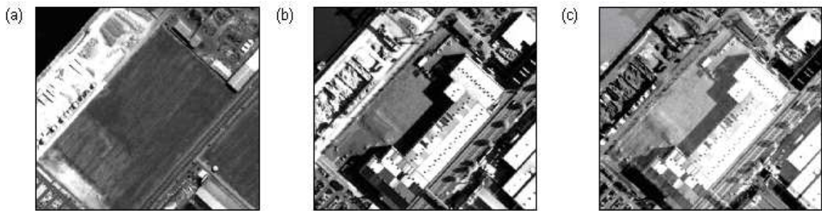
Abbildung 2.18: Ausschnitt aus den Luftbildern von (a) 1984 und (b) 1996, (c) Differenzbild, wobei sehr negative Differenzwerte sehr dunklen Grauwerten entsprechen, sehr positive Differenzwerte entsprechend durch sehr helle Grauwerte dargestellt werden.
