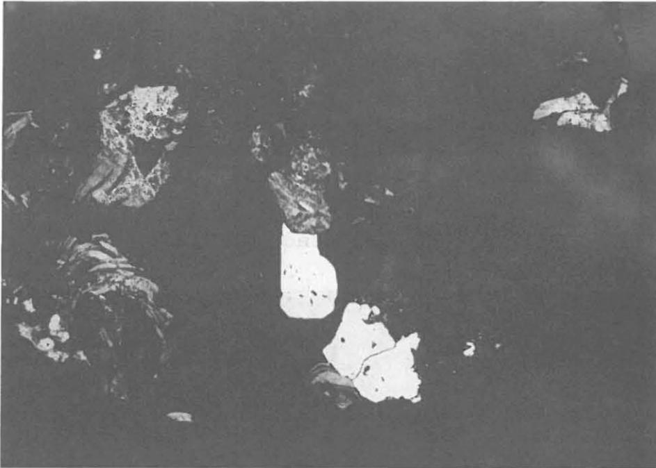
Abb. B.3.12: Idiomorpher bis hypidiomorpher Pyrit (weiß) und leistenförmige bis aufgerollte Graphitaggregate (wechselnd diffus-grau) in einer Cuttingprobe aus Paragneis aus 1950 m (Anschliff CUT1950, 1950 m, 160fach, 1 Nicol, Luft).
