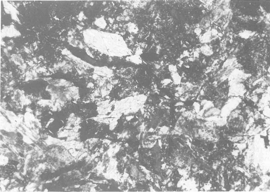
Abb. B.7.6: Kataklasit, entstanden aus Amphibolit: Hornblende- und Plagioklas-Klasten in einer Matrix aus zerriebenem und stark serizitisierten Plagioklas, zerriebener und chloritisierter Hornblende und Ilmenit als Opakphase. (DS HC1200, x Nicols , lange Bildkante entspr. ca. 2,2 mm)
