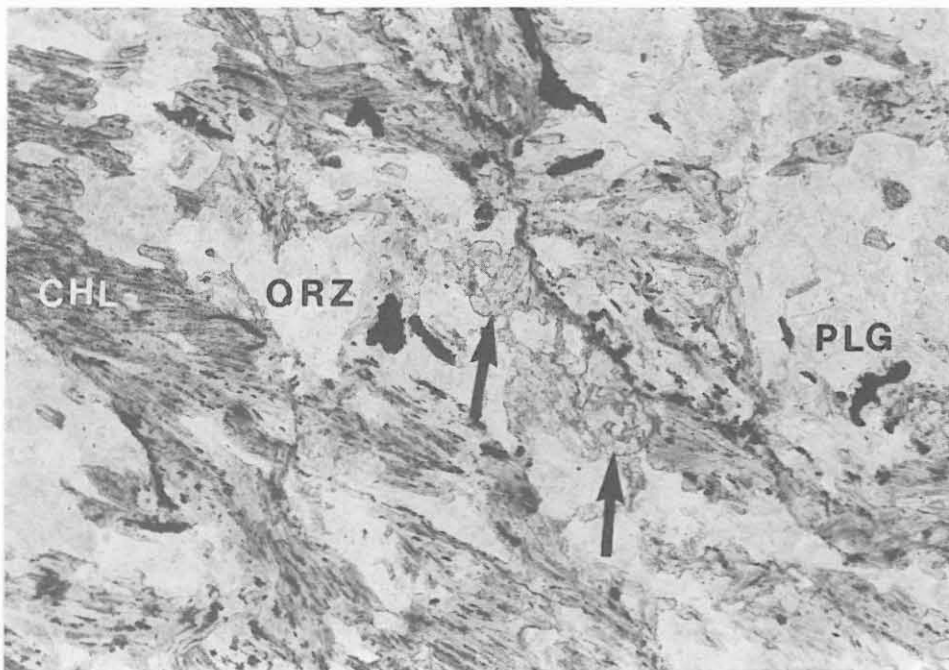
Abb. B.3.4: Völlig alterierter Granat-Muskovit-Biotit-Gneis aus der Probe HC0720. Die Basisspaltbarkeit der ehemaligen Biotite wird von Rutil- und Ilmenit-Einschlüssen nachgezeichnet. Die einschlußfreien Chlorit-Aggregate in der Bildmitte sind Pseudomorphosen nach Granat. Die größeren, nichtorientierten Opakörner bestehen weitgehend aus Pyrrhotin (lange Bildkante entspr. 2,6 mm, // Nic.).
