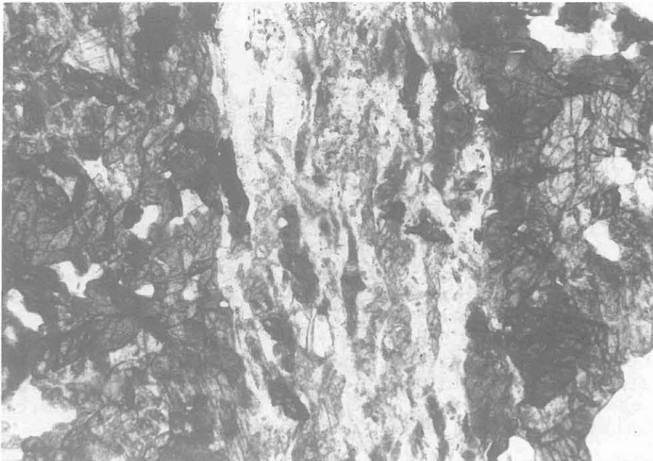
Abb. B.7.7: Titanit, Epidot und Aktinolith und stark alterierter Plagioklas bilden die Hauptkomponenten des retrograd überprägten Amphibolits; eingeregelte Bruchstücke dieser Minerale schwimmen in der Prehnit-Kluft. (DS HC1562, // Nicols , lange Bildkante entspr. ca. 1,8 mm)
