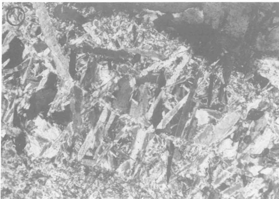
Abb. B.7.14: Senkrecht zur Kluft im Amphibolit gewachsene Laumontit-Kristalle. (DS HC1394, x Nicols, lange Bildkante entspr. ca. 0,5 mm)
