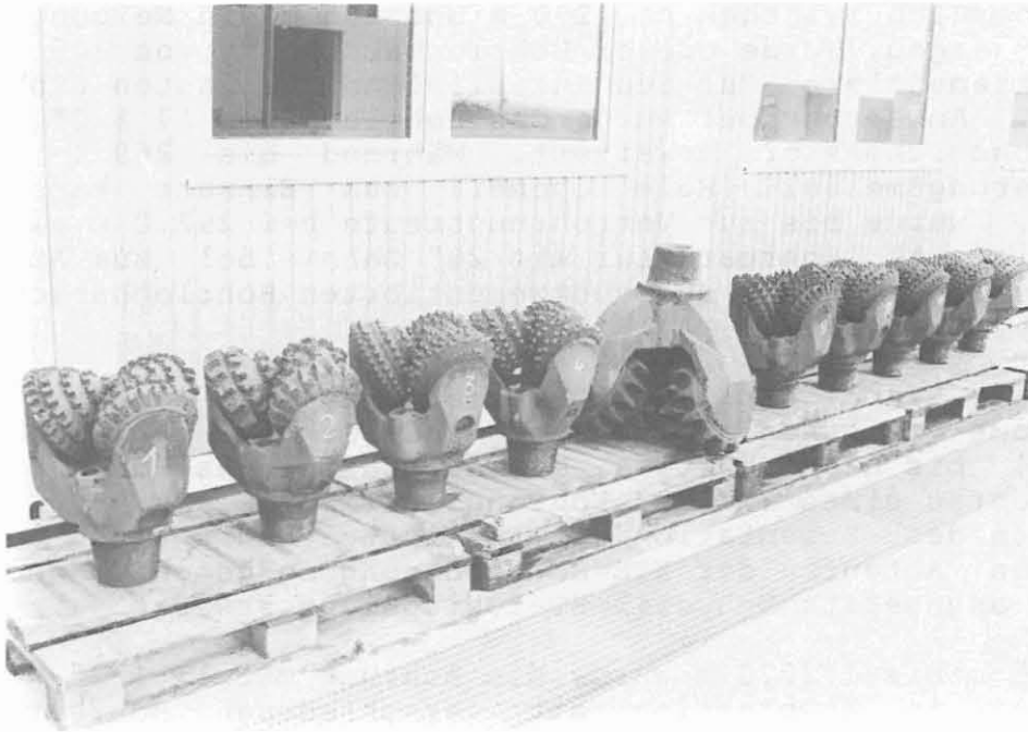
Abb. A.2.2: Beim Vorbohren bis 305 m eingesetzte 17 1/2" Warzenmeißel mit einem zum Zementaufbohren verwendeten 28" Zahnmeißel
