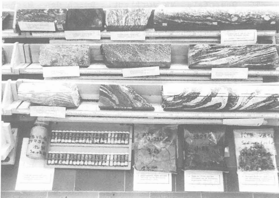
Abb. A.3.1: Übersicht über die verschiedenen Feststoffproben aus der zu 90% gekernten Vorbohrung KTB Oberpfalz VB
