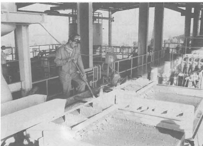
Abb. A.3.1.4: Gewinnung von grob- körnigen Bohrklein- proben aus einem Schüttelsiebkasten, in dem auch eine Gas- falle installiert ist
