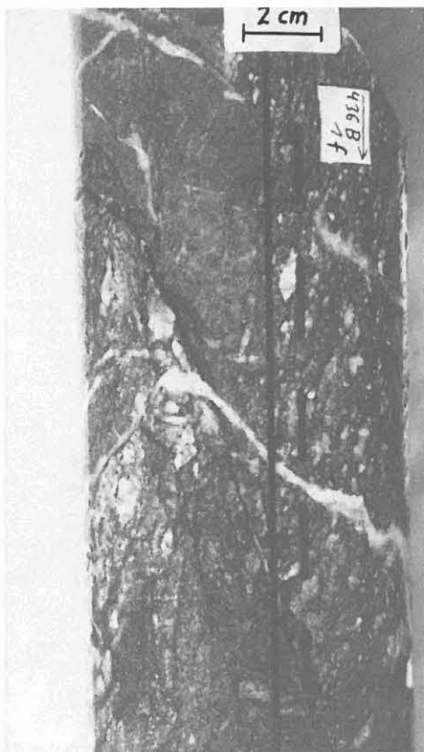
Abb. E.2.13: Eine diskrete Aufschiebung wird von einem Quarzgang durchschlagen. Man beachte die Riedel-Scherflächen welche zur Aufschiebung konjugiert sind. Der Quarzgang selbst wird entlang jüngerer Abschiebungen leicht versetzt (rechte Bildhälfte). Kst.-Nr. 436B1f, ca. 1933 m.
