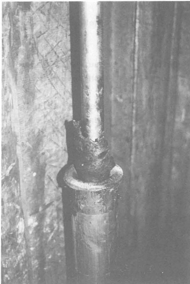
Abb. 17: Zerstörte Packerelemente nach dem Ausbau aus der Setzteufe von 3 808,6 m
