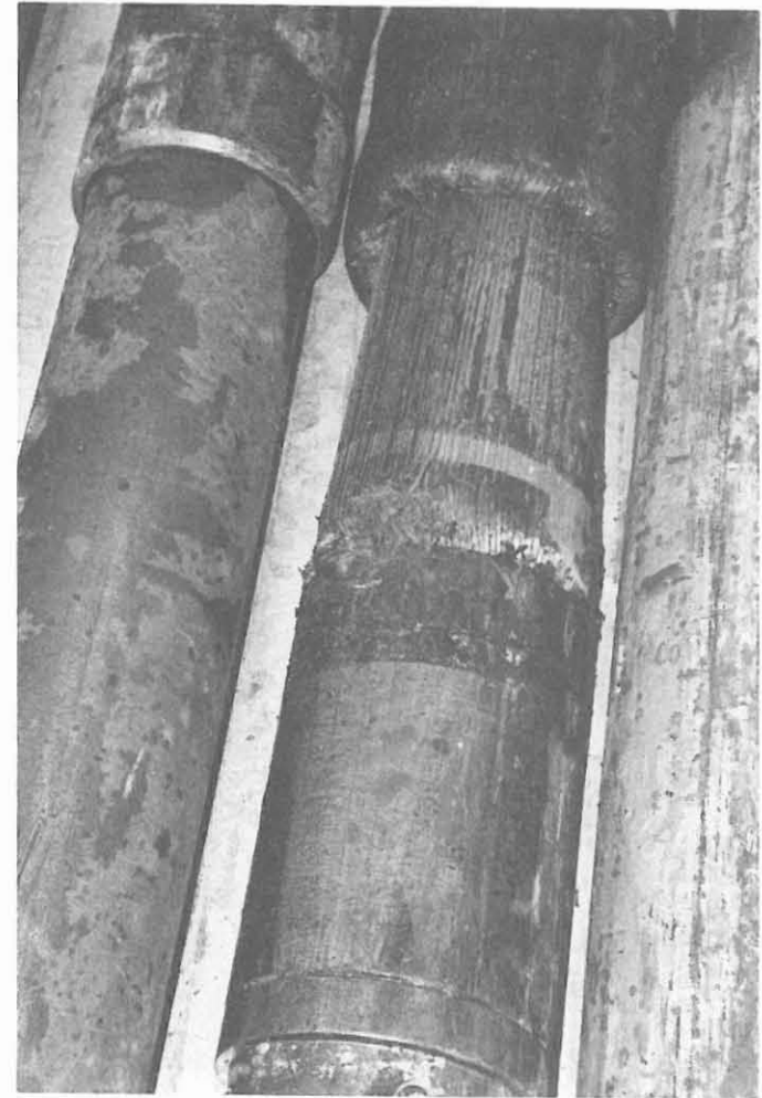
Abb. 4: Zerstörte Packerelemente nach Beendigung des Tests DST 3
