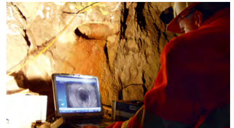
Die Sonde ist mit einer Kamera ausgestattet, die Bilder aus dem Bohrloch direkt auf den Bildschirm liefert.
