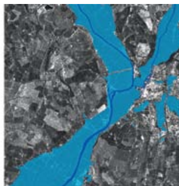
Links: Künstlerische Darstellung von TerraSAR-X über Europa; rechts: Wasserfläche der Überflutung um Tewkesbury, England, im Juli 2007, abgeleitet aus hochauflösenden TerraSAR-X-Daten; dunkelblau: Normalwasserpegel, hellblau: Überflutungsfläche (beide Abbildungen: DLR, Oberpfaffenhofen)
