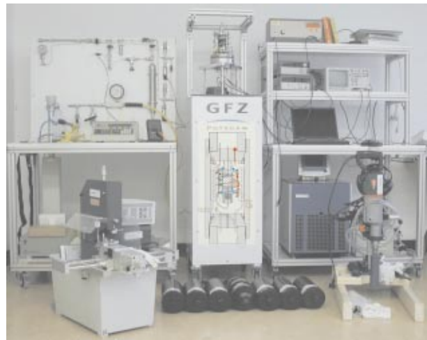
Abb. 11: FLECAS („Field Laboratory Experimental Core Analysis System“) im Inuvik Research Institute, Kanada. Im Vordergrund: Geräte für die Probenpräparation und Transportgefäße (Foto: H. Kulenkampf, GFZ).
