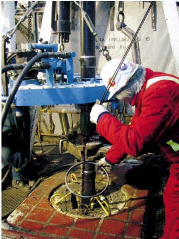
Abb. 14: Permanente Installation der faseroptischen Sensorkabel. Die Messkabel wurden mit Hilfe spezieller Kabelschellen befestigt und zusammen mit der Verrohrung in das Bohrloch eingebaut (Foto: J. Henniges, GFZ).
