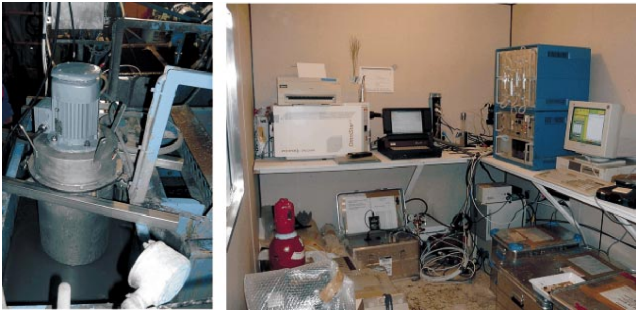
Abb. 8: (Links) Entgaser zur mechanischen Freisetzung der Gase aus der Bohrspülung. (Rechts) Messcontainer mit Analysegeräten: Massenspektrometer (links oben), Gaschromatograph (rechts oben) und Radon-Detektor (links unten) (Foto: T. Wiersberg, GFZ).
