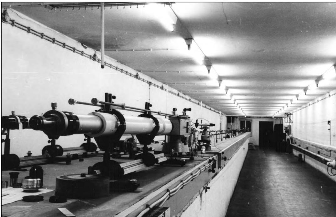
Der Komparator wurde in einem speziell für ihn errichteten Komparatorhaus an der Internationalen Standardbasis Potsdam aufgestellt. Seine Elemente sind auf einem Pfeiler, der unabhängig vom Gebäudefundament gegründet wurde, angeordnet. Die 24-m-Strecke lässt sich mit einer Unsicherheit von etwa  $8 \mu\text{m}$  reproduzieren. Die Länge eines Invarmessbandes kann mit einer Unsicherheit von  $20 \mu\text{m}$  bestimmt werden.
