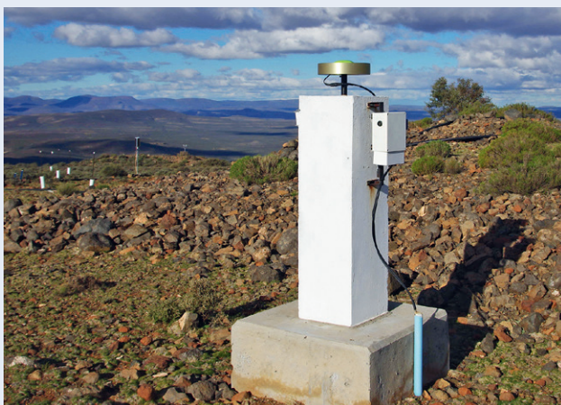
Abb. 7: Im Vordergrund: Geodätische GNSS-Bodenstation in Sutherland, Südafrika. Im Hintergrund links: klassische Bodenfeuchtesensoren (Foto: M. Ramatschi, GFZ)
