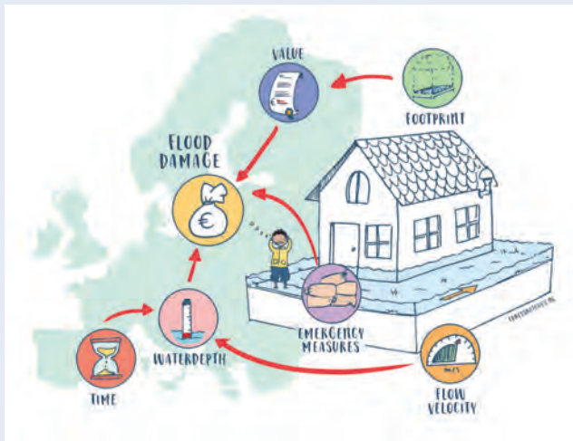
Abb. 5: Ein Bayessches Netz, hier schematisch dargestellt, ist ein gerichteter azyklischer Graph, in dem die Knoten Zufallsvariablen und die Verbindungen bedingte Abhängigkeiten zwischen den Variablen beschreiben. Jedem Knoten ist eine bedingte Wahrscheinlichkeitsverteilung der durch ihn repräsentierten Variable hinterlegt. Bayessche Netze helfen Hochwasserschädigungsprozesse auf der Gebäudeskala besser zu verstehen und werden zur Schadensmodellierung von lokaler bis kontinentaler Skala verwendet (IMPRES, 2018).
