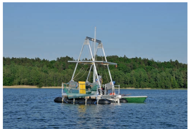
Abb. 2: Niederreiter-Bohrplattform auf dem Czechowskie-See (Polen, 2012) (Foto: B. Brademann, GFZ)
