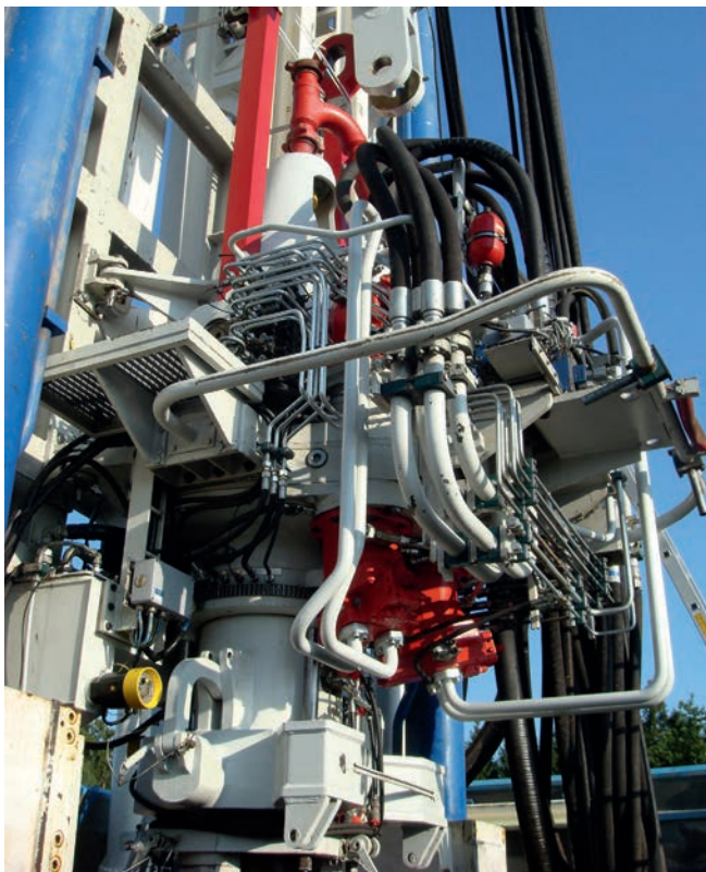
Abb. 1: Hydraulisch angetriebener Topdrive des Typs HV TD 350H am tiefsten Punkt des Masts im Hebewerk hängend. Eine Kombination von starren Hydraulikleitungen und flexiblen Hochdruckschläuchen versorgen die hydraulischen Antriebsmotore (rote Bauteile). Die blauen Bauteile am Bildrand stellen die Hebewerkzylinder dar. (Foto: A. Jurczyk, GFZ)
