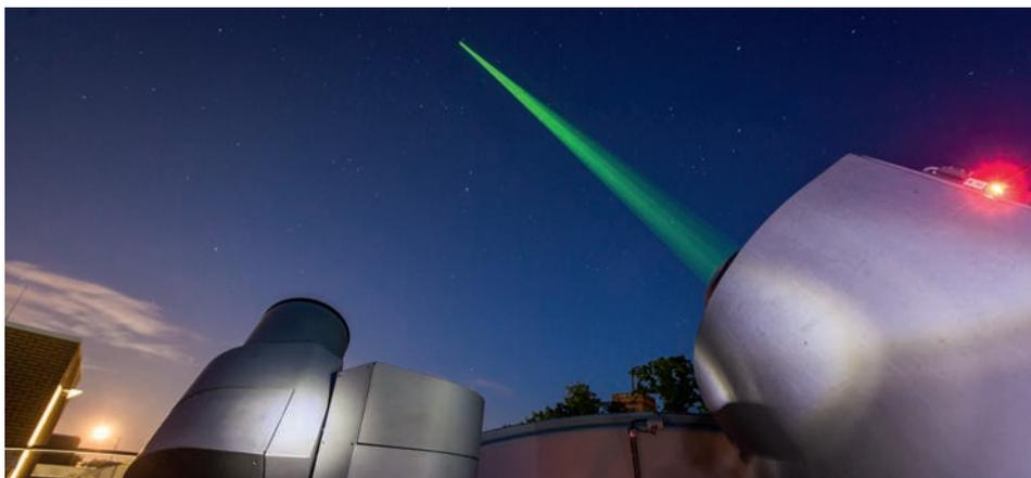
▲ GFZ-Laser-Ranging-Station im Nachtbetrieb während der Beobachtung eines Galileo-Satelliten in rund 20.000 Kilometer Entfernung. (Foto: DiGOS GmbH)
