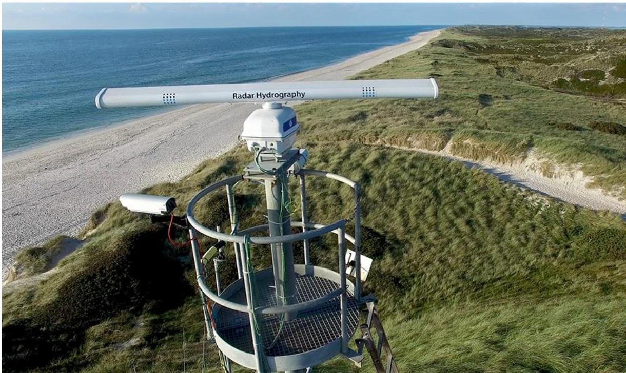
Abb. 2: Spezielle Radargeräte und moderne Videotechnik werden entwickelt und eingesetzt, um die Dynamik der Wellen zu erforschen (Bunker Hill auf Sylt). (Foto: Jochen Horstmann/HZG)
