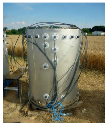
Abb. 3: Links: Stechen eines SoilCan Lysimeters am TERENO-Standort Dedelow; rechts: SoilCan Lysimeter mit unterschiedlicher Sensorik zur Messung von Bodenparametern (Fotos: W. Hierold, ZALF)
