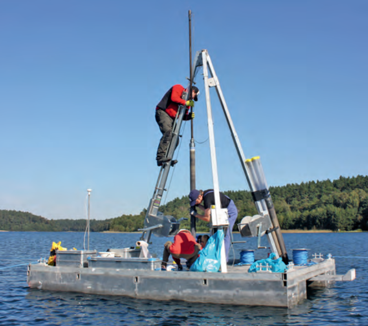
Abb. 4: ICLEA-Bohrkampagne zum Bergen von jahresgeschichteten Seeablagerungen des Großen Fürstenseer Sees (Mecklenburg-Vorpommern)
