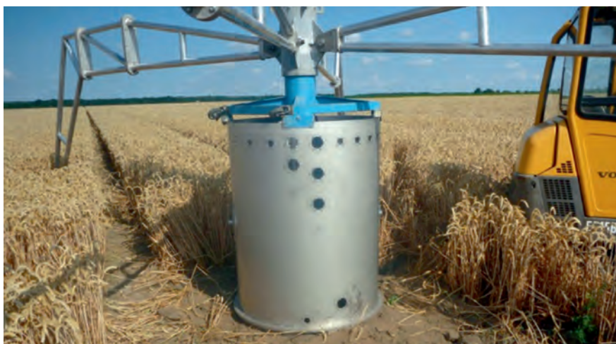
Abb. 3: Links: Stechen eines SoilCan Lysimeters am TERENO-Standort Dedelow; rechts: SoilCan Lysimeter mit unterschiedlicher Sensorik zur Messung von Bodenparametern (Fotos: W. Hierold, ZALF)
