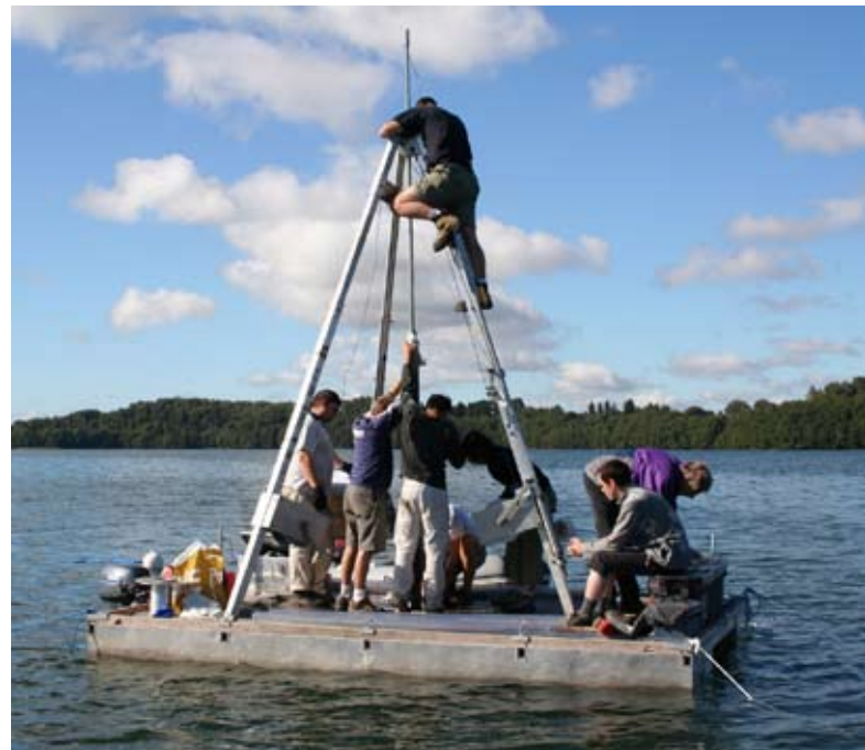
Abb. 1: Entnahme von Seesedimenten mit einem modernen Stechkernsystem
